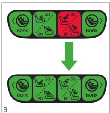
Visningen på basen skall skifta om till grönt. Kontrollera att läsningen är säker genom att lyfta skalet.
