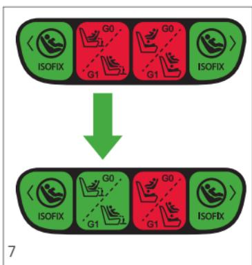
Vid en korrekt inställd längd växlar visningen för stödfoten om till grönt så snart basen sätts ned i bilens golv. Om detta inte skulle vara fallet kör du ut stödfoten ytterligare något såsom beskrivs ovan.
