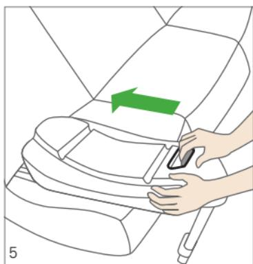
Trekk nå i midthåndtaket og trykk understellet samtidig litt i motsatt retning, dvs. i pilens retning. Hvis man løfter understellet litt, er det enklere å justere det.
