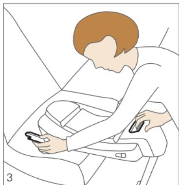
Zum Ausfahren der Isofix-Konnektoren betätigen Sie den Griff vorne in der Mitte der RECARO SmartClick und ziehen Sie die Konnektoren bis zum Anschlag aus.
