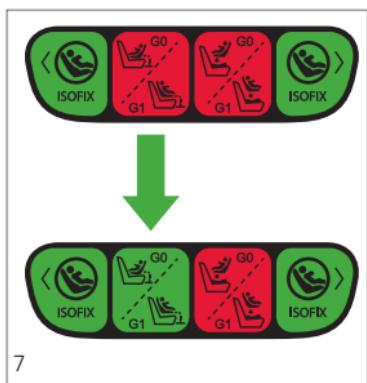
При правильной установке длины индикатор опорной стойки становится зеленым как только Вы поставите базу на пол автомобиля. Если этого не произойдет, следует еще немного вытянуть опорную стойку способом, описанным выше.
