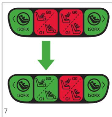
Bei richtig eingestellter Länge wechselt die Anzeige für den Stützfuß auf grün sobald Sie die Basis auf dem Fahrzeughoden abstellen. Sollte dies nicht der Fall sein, fahren Sie den Stützfuß wie oben beschrieben noch etwas weiter aus.
