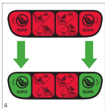
Setzen Sie nun die RECARO SmartClick an den Bügeln an und lassen Sie die Konnektoren hörbar einrasten. **Wichtig:** Beide Anzeigen müssen auf Grün wechseln. Kontrollieren Sie zur Sicherheit das sichere Verrasten durch Ziehen an der Basis.
