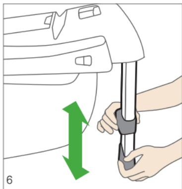
Zum Einstellen der Stützfußhöhe betätigen Sie die Verriegelung an der Hinterseite des Stützfußes und ziehen Sie den Stützfuß bis zur benötigten Länge aus. Achten Sie darauf, dass der Stützfuß einrastet.
