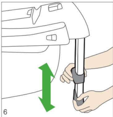
För att ställa in stödfotshöjden trycker du på låsningen på baksidan av stödfoten och ut stödfoten till den erforderliga längden. Kontroller att stödfoten hakar i.
