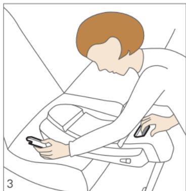
Для того чтобы выдвинуть коннекторы Isofix, приведите в действие рукоятку расположенную в середине передней части RECARO SmartClick, и вытяните коннектор до упора.
