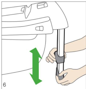
Для регулировки высоты опорной стойки приведите в действие фиксирующее устройство на задней стороне опорной стойки и вытяните опорную стойку до необходимой длины. Проследите за тем, чтобы опорная ножка была зафиксирована.
